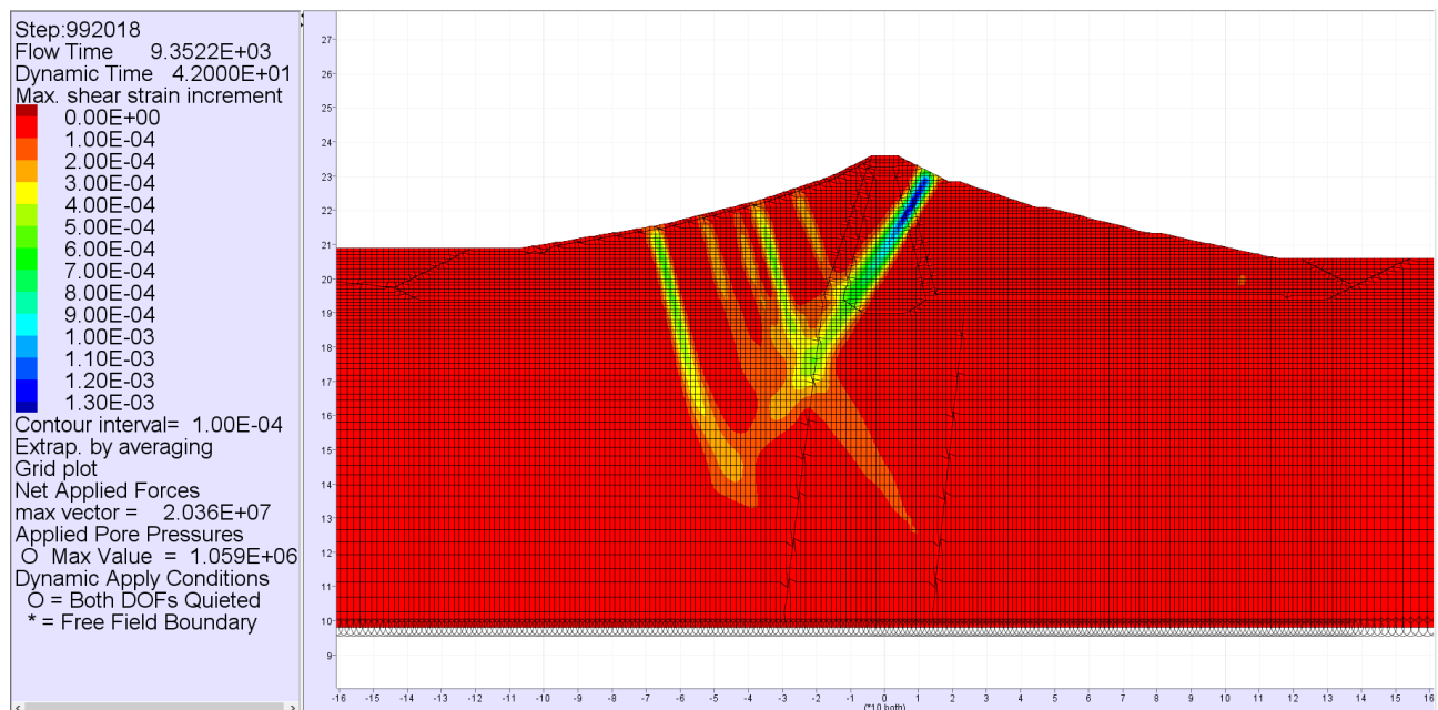
Figura 4.1-5 Campo della deformazione di taglio nella diga – Verifica allo Stato Limite di Danno – invaso vuoto – input sismico 01 – Sarnano.
